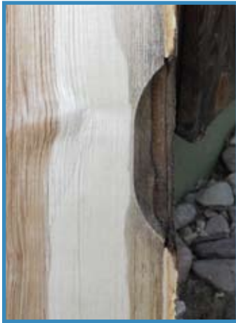
Foto 4 Onbehandelde es met omvangrijke verkleuring in axiale richting
