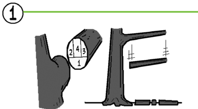
1 Snede voor het horizontaal laten vallen van een tak: zo diep mogelijke ondersnede, diepe spintsnedes en zo snel mogelijk de breuklijst doorzagen.
