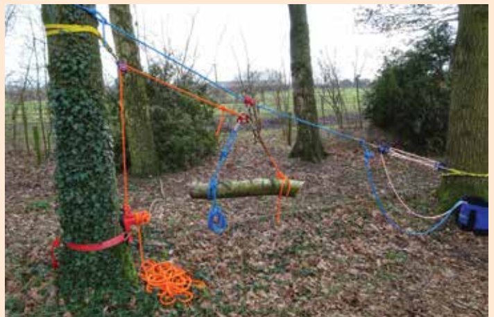
Opgespannen kabelbaan met remlijn
