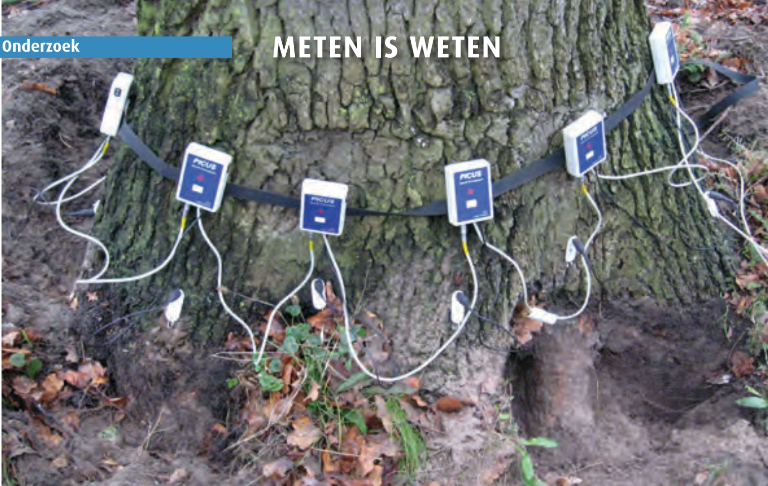
Figuur 1: Opstelling van een meting van een geluidstomogram.
