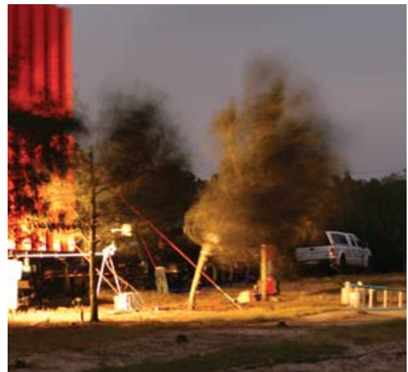
4. Boom onder stormbelasting met meetinstrumenten op de stam.
