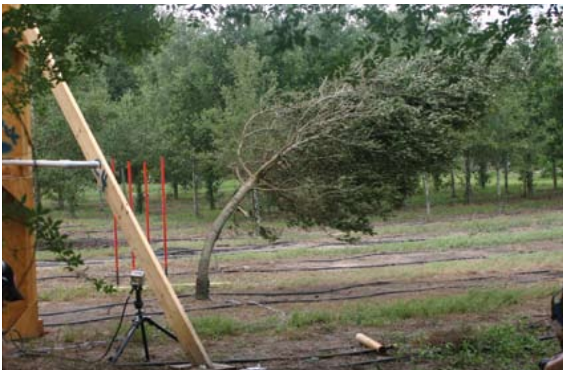
3. Opstelling van de stormproef in Florida, rechts voor een boom die wordt getest.
