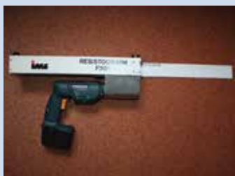
Resistograaf Trek- of stabiliteitsproef bij paardenkastanje Museum Rijswijk.
