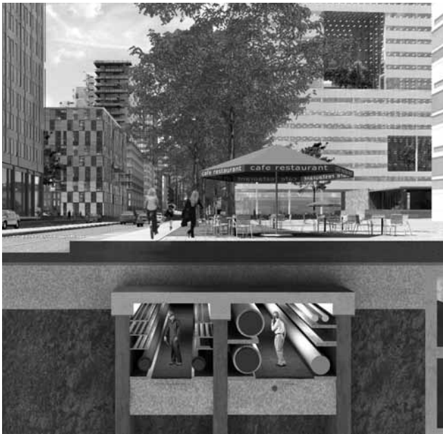
De Integrale Leidingen Tunnel is vijfhonderd meter lang, menshoog en zes en halve meter breed. In het zuidelijke deel, links, liggen de kabels en leidingen die warmte afgeven. In het noordelijke deel, rechts, liggen de koude kabels en leidingen. De telecomleidingen liggen in beide tunnels onder de vloer. Kosten 9 miljoen euro
